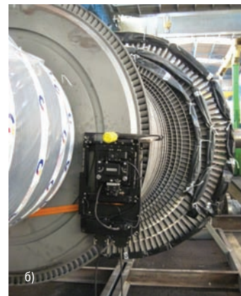
СОЛВЕР Пайп, закрепленный на образцах: а) на трубе; б) на роторе паровой турбины
