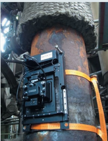
Пример крепления прибора на трубе
