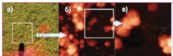
Рис.3 а) Изображение выбранного для эксперимента участка поверхности, полученное с помощью оптического микроскопа (размер поля 350x350 мкм); б) АСМ-изображение выбранного для эксперимента участка поверхности (размер скана 10x10 мкм); в) АСМ-изображение того же участка (размер изображения 3,5x3,5 мкм)
